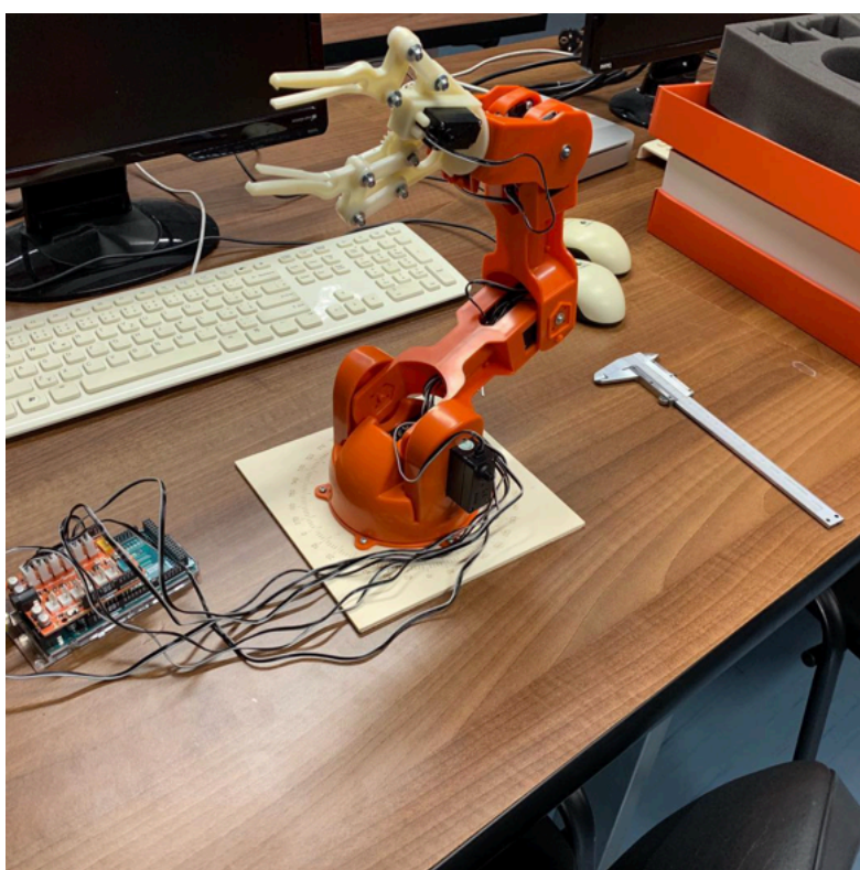
Skladanie a oživenie stavebnice robotického ramena
