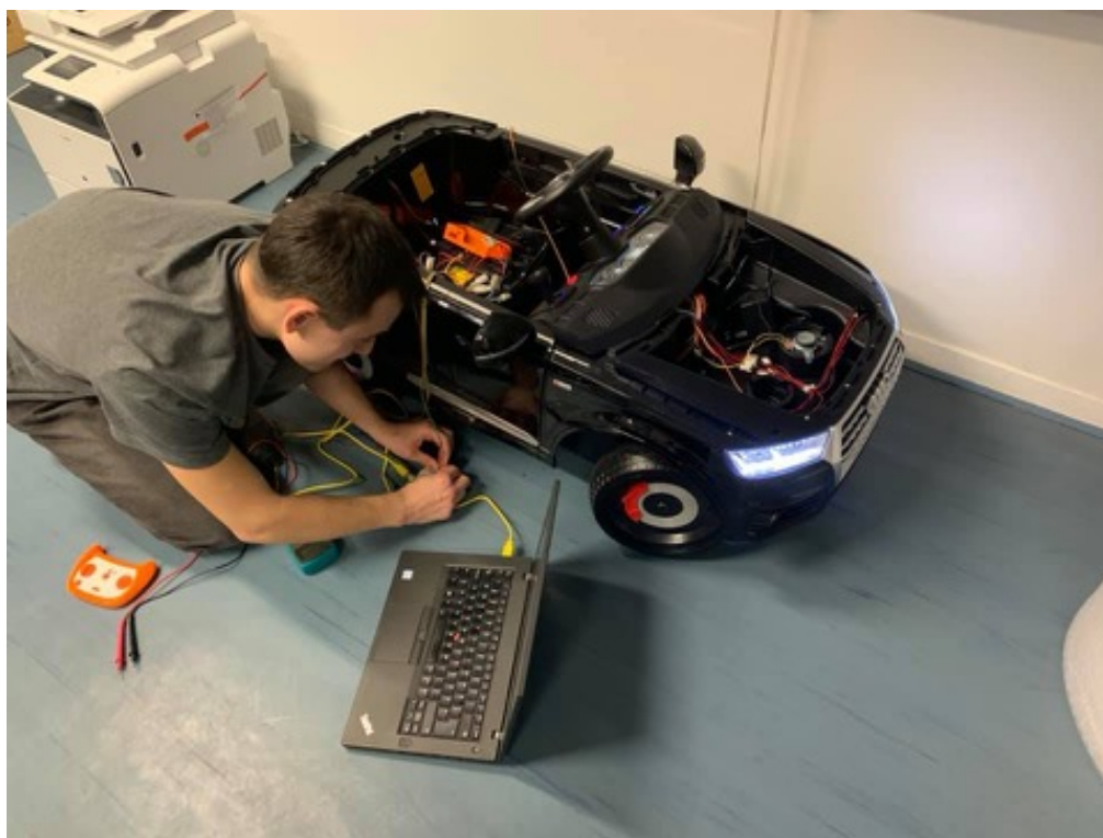
Úprava podvozku a montáž komponentov pre vytvorenie autonómneho vozidla so systémami ADAS
